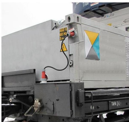
69. ábra – Példák az ADGU pórekocsi villamosenergia-hálózatába történő bekötésére, a – az ADGU „Progresszor-01” bekötése; b — az ADGU RKV-15 bekötése
